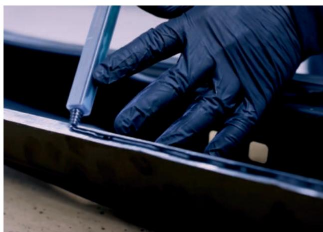
Le joint de collage et d'étanchéité est un produit polyuréthane monocomposant et élastique qui adhère très bien et durcit sous l'action de l'humidité et de l'air. Les parties collées ou étanchées sont recouvrables avec des peintures acryliques et bicomposantes.
